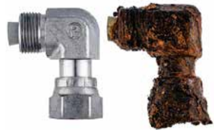
ToughShield Plus (links) und verzinkte Schwenkverschraubungen (rechts) nach 3.000 Stunden SST
