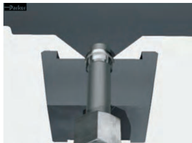
Das Rohr wird bis zum Anschlag in das Werkzeug eingeführt
