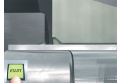
Nach Starten des Prozesses wird das Rohr gespannt und der Dorn wird in das Rohrende getrieben
