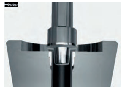
Die vordere Fläche wird kontinuierlich gerollt und verdichtet. Das Rohr wird von innen geringfügig geweitet, um es an der Hülse zu klemmen
