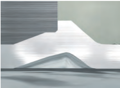
Mit Aufliegen der Werkzeuge ist der Umformprozess abgeschlossen
