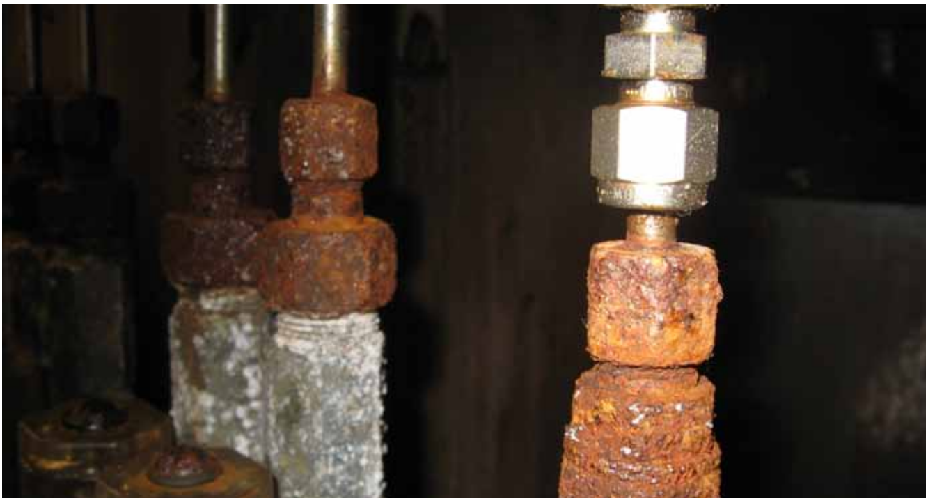
Galvanische Reaktion durch Kombination von verschiedenen Materialien für Verschraubungskörper und Überwurfmutter.
