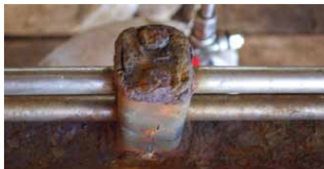
Spaltkorrosion an der Rohr/Abscheider-Schnittstelle.
