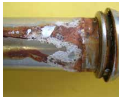
Abbildung eines Niedrigkostenprodukts. Korrosionsschaden durch eine minderwertige Härtingung des hinteren Klemmrings
