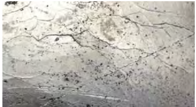
Spannungskorrosionsrisse in Edelstahl in Salzwasserumgebungen
